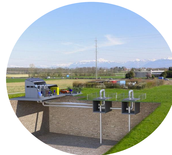
Géothermie de moyenne profondeur, Vinzel
